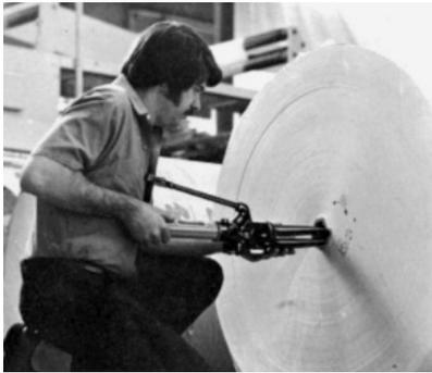
Mark IIは使用が容易で、一人で壊れたロールの修復が3分で出来ます。内径70mmから76mmのコア付き、幅1,143mm迄のロールが容易に処理出来ます。
